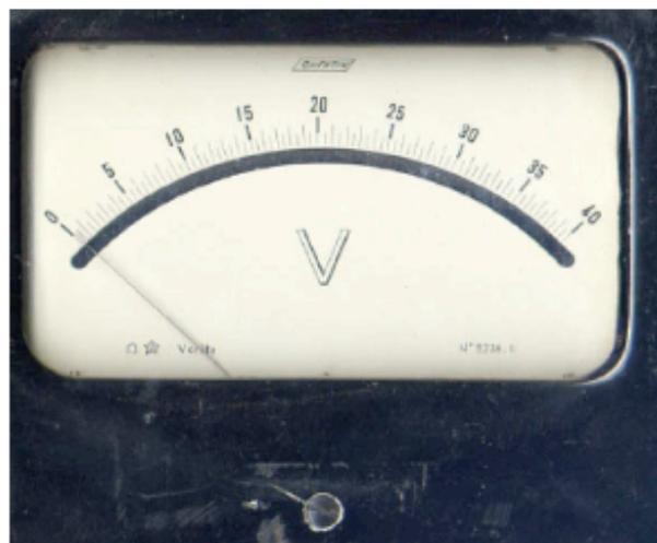
*cadran d'un voltmètre à aiguille*
